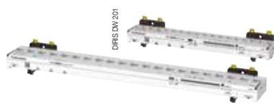
**DIRIS Digiware BCM** est un module de mesure de courant multi-départs avec 18 ou 21 capteurs intégrés et permet la surveillance de tous les types d'unités de distribution d'énergie (PDU) dans les data center. Ces modules sont également équipés de trois canaux RJ12 permettant de les raccorder à des capteurs de courant TE/TR/ITR/TF à l'aide de câbles RJ12 et divers tores différentiels ΔIC.
