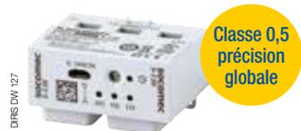
**DIRIS Digiware S** est un module de mesure de courant multi-départs avec 3 capteurs intégrés et permet la surveillance de de départs triphasés ou monophasés jusqu'à 63 A. Positionnés directement sur ou sous les appareils de protection, ils s'associent au module de mesure de la tension DIRIS Digiware U pour mesurer les consommations, surveiller l'installation électrique et la qualité de l'alimentation.
