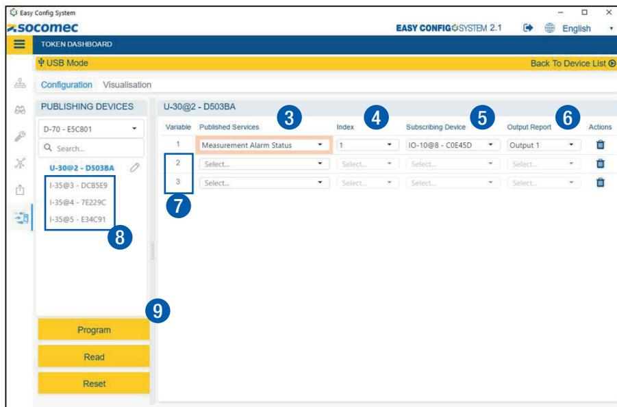
**i** Une fois que le Jeton est configuré, la vitesse de communication du bus Digiware est automatiquement modifiée à 500 kbps (module U-xx et afficheur/passerelle D-xx/M-xx) et la LED COM des modules Digiware se met à clignoter rapidement.
