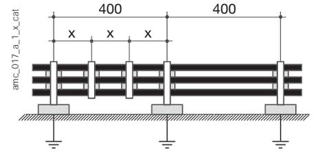
Les barres souples doivent être fixées sur des supports isolants à une distance maximale de 400 mm. Il est nécessaire de solidariser les barres entre elles par des colliers. La distance entre colliers successifs est fonction des contraintes électro-dynamiques en cas de court-circuit. Le tableau ci-contre précise les distances préconisées entre colliers.
