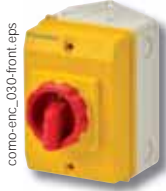
COMO enclosure 20 to 125 A Polycarbonate - IP65
